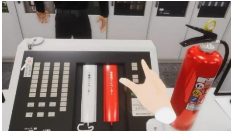
①非常用エレベーターの強制呼び戻し
