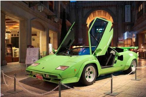
カウンタックが市販されたのは1974年。デザインは、ミウラのデザインにも関わったベルトーネのマルチェロ・ガンディーニが手がけた。ウェッジシェイプの考え方を、ぎりぎりまで追求した面と線との融合は、近未来を予想させるに十分で、縦に跳ね上げる独特のドアも、その後のランボルギーニのアイデンティティとして育っていくことになる。このLP400は1978年にデビュー。もとはといえばカナダの石油王のウォルター・ウルフのためにチューンナップした初代のウォルター・ウルフタイプが、LP400Sのプロトタイプとして生かされたといわれている。市販されたLP400Sは、排気量こそLP400と同じ3929ccだったが、各部に改良が加えられ、途中でボディラインそのものの変更を受けるなど、合計237台のLP400Sは、造られた時期によって、詳細がかなり異なる。
