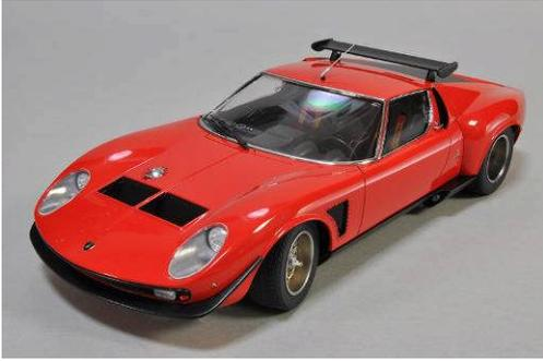
その特異な成り立ちと数奇な運命から、スーパーカー最大のミステリーとされているイオタ。こうして展示されることはとてもレアなケース。ランボルギーニのテストドライバー、ボブ・ウォレスの発案により、事故車のミウラをベースに、当時のF1レースレギュレーションに合わせ1969年から1970年にかけて製作された。シャシーに大幅な軽量化と剛性アップが図られ、サスペンションも新たに設計された。ボディは軽量なアルミ製。エンジンは圧縮比をアップしカムプロファイルの変更などにより440PSを発揮していたという。またミウラの特徴でもあったポップアップ式のヘッドライトが埋め込み式に変更されている。しかし、イオタは実際レースに参戦することはなく、完成後諸々の社内テストに供され、ミウラS、SVを開発するにあたっての貴重なデータを残したといわれている。
