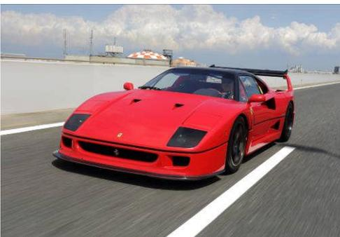
わずかに 5 台作られたコンセプトモデルの“エヴォルツィオーネ”で開発がすすめられ、フェラーリ社 40 周年のメモリアルモデルとして 1984 年にデビューしたのが F40。288GTO の後継車という位置づけでもある。F40 は先代の 288GTO と比べてひと回り大きい(4538mm×1970)。それにもかかわらず 288GTO に比べて約 60 kg の軽量化にも成功している。チューブラーフレームのシャシーに、カーボンコンポジットのパーツを特殊な接着剤で張りつける方法で、高い強度を確保しながら、大幅な軽量化が達成できた。エンジンは熟成の進んだ V8DOHC で、排気量は 288GTO よりもアップした 2936cc。またツインターボのターボチャージャーにはインタークーラーが追加された。最高出力は 478hp/7000rpm。公表されている最高時速は 324km/h に達する。1992 年に生産を終了するまでに 1311 台が造られた。
