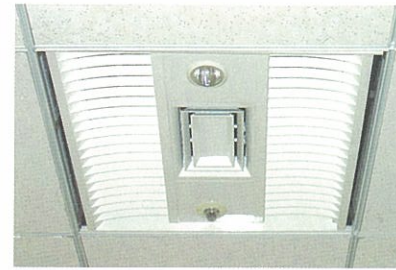
本体：鋼板0.6mm厚、ホワイト塗装 ランプ：T5 24W×2灯 ルーバー：遮光角30°
